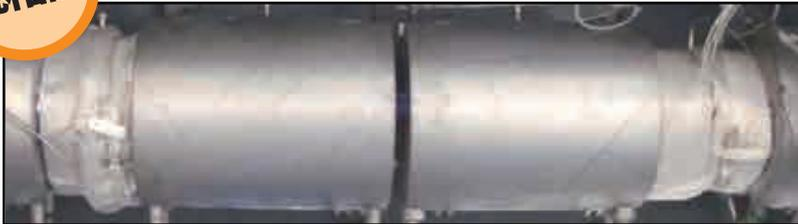
熱電対・ケーブルを避けながら、ヒーター高温部と電極を覆っています。
